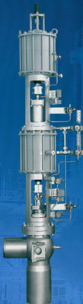
带快速开启功能的减压阀门 DN 200/350 PN 250/100 气动活塞驱动 Abu Qir III 埃及
